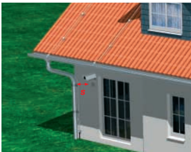
Správně dodržena oddělovací vzdálenost „s“ mezi svodem a bezpečnostní kamerou.
