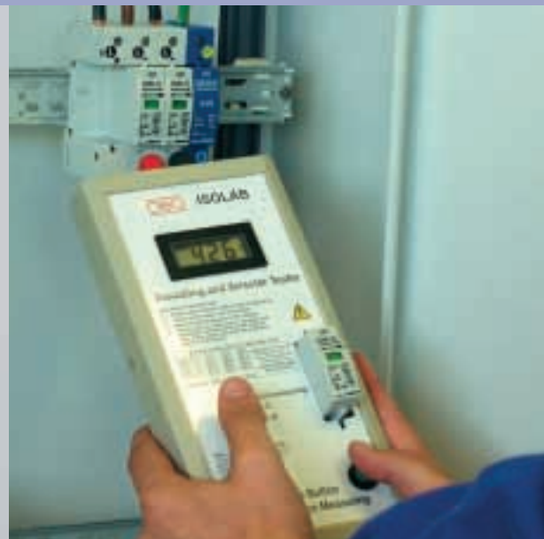
Měření svodičů přepětí
